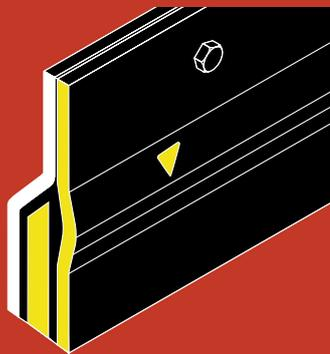
Die Keramik ist in Gummi eingebettet und wird durch die beiden Stahlbleche geschützt. Abfahrmarkierungen zeigen den Verschleißstatus an und die Restteile können umweltschonend recycelt werden.
