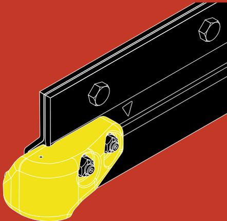
Der Randsteinabweiser wird einfach mit der, mit Befestigungslöchern vorbereiteten, Schneeräumleiste verschraubt und bietet so optimalen Schutz der Kanten. Ein einfaches Austauschen des Randsteinabweisers ist jederzeit möglich.
